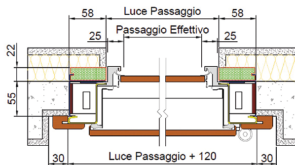
Porta blindata: Controtelaio coibentato con sottosoglia in legno lamellare
