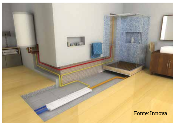
Dispositivo per il recupero del calore dall'acqua di scarico della doccia.
