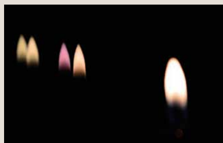
Coating bassoemissivo (fiamma violacea sulla lastra interna)
