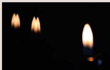
Vetro float senza coating (fiamme gialle)
