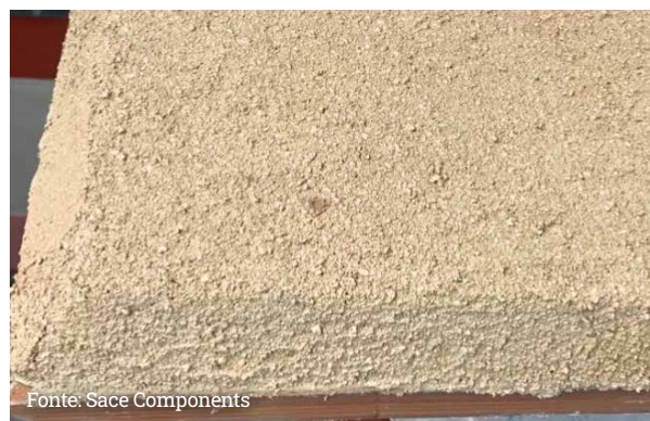
Intonaco termoisolante di sughero e calce
