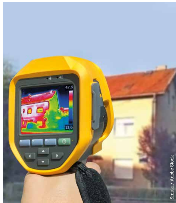
Termografia di un edificio dove si evidenziano le aree di maggiore dispersione termica.
