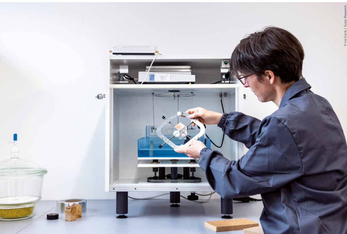
Figura 5. Alcune immagini dello svolgimento di test nell'Hygrothermal testing Lab. A sinistra misurazione dell'isoterma di assorbimento in regime super-igroscopico con estrattori a pressione; a destra misurazione dell'assorbimento di acqua per immersione parziale.
