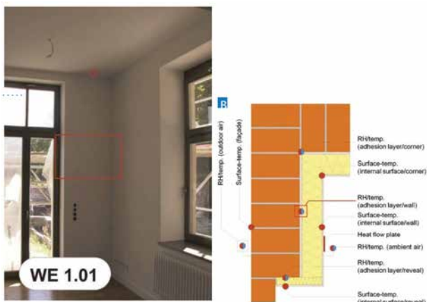
Fig. 4: Punto di misura esemplificativo per misurazioni a lungo termine in Güterfelde. A: posizione dell'area del sensore dopo (qui: angolo esterno muro con fuga, posizione NOI 1.01). B: Mappa dei punti di misura.
