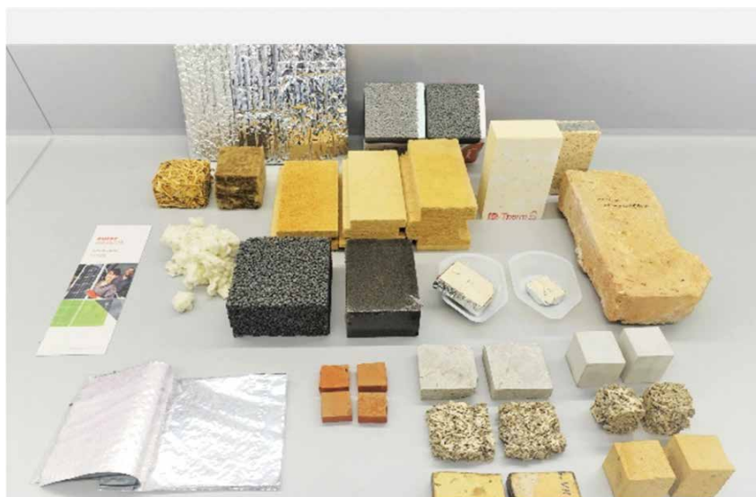
Figura 4. Campioni di prova estratti da diverse tipologie di materiali da costruzione testati presso l'Hygrothermal Testing Lab. Credits: Daniel Herrera / Eurac Research.
