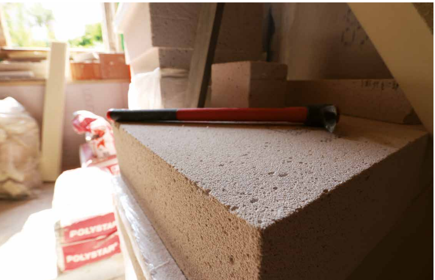
Dall'interno: Pittura ai silicati, rasatura armata, pannello schiuma minerale, strato di malta, intonaco di livellamento, muro in pietra locale cm 50, intonaco esterno.
