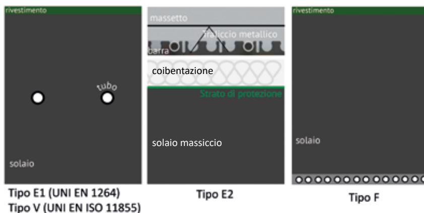
Figura 2. Tipologie di sistemi radianti nelle normative
